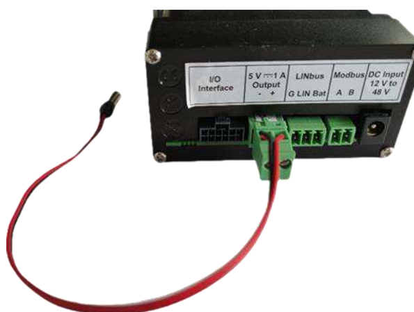
الشكل 7 موصل خرج طاقة التيار المستمر مع كابل لتوصيل الطاقة M2M
